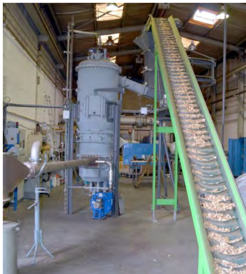
Pilote de gazéification dans les locaux de Cogebio à Loyette, photo FD
