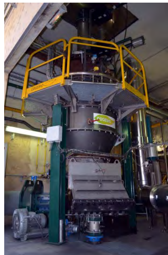
Le gazéifieur de 1,5 MW chez Guyenne Papier, photo FD
