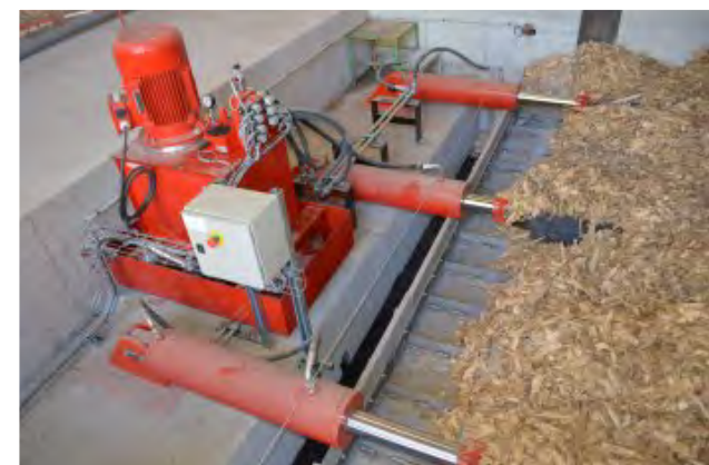
Système d'extraction du silo à bois déchiqueté de Guyenne Papier, photo FD
